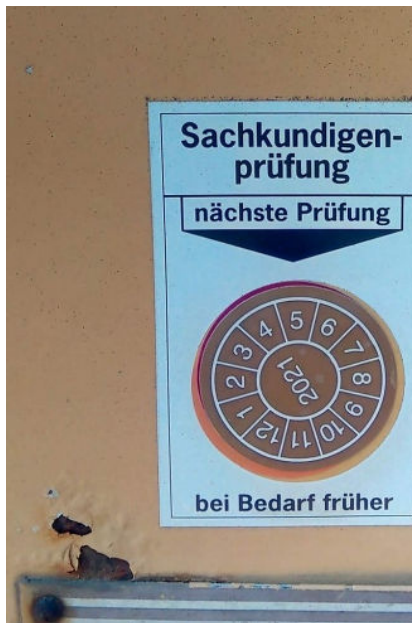
Abb. A-2: Prüfkennzeichnung. Die Plakette ist ein Hinweis, aber kein vollständiger Prüf- oder Zustandsnachweis.
