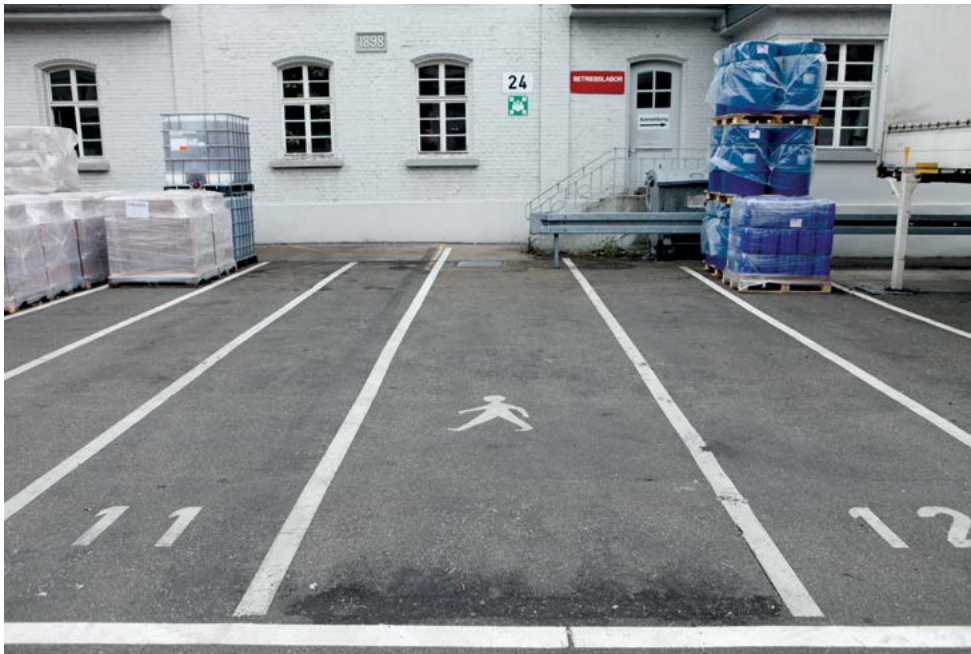
Abbildung 17: Zeilenlager im Freien mit Bodenmarkierung
