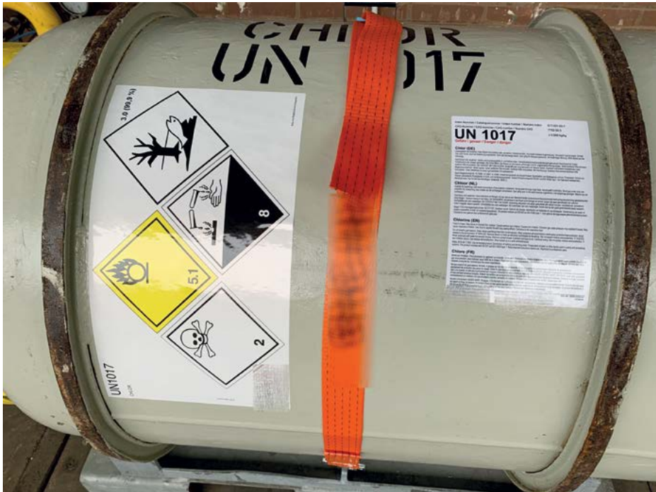
Abbildung 26: Bergebehälter für Druckgasbehälter
