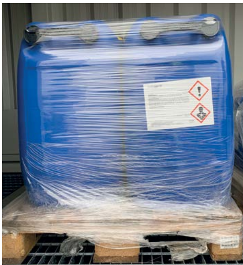
Abbildung 20: Mit Stretchfolie und Bändern gesicherte Palette
