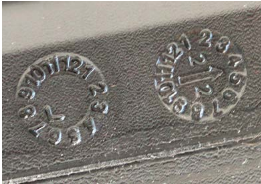
Abbildung 5: „Kunststoffuhr“ auf dem Boden eines Kraftstoffkanisters
